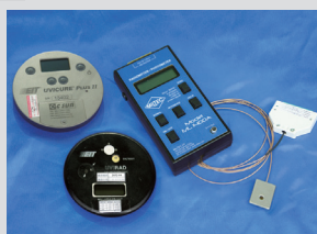
紫外線量測表 EIT UV Meter
